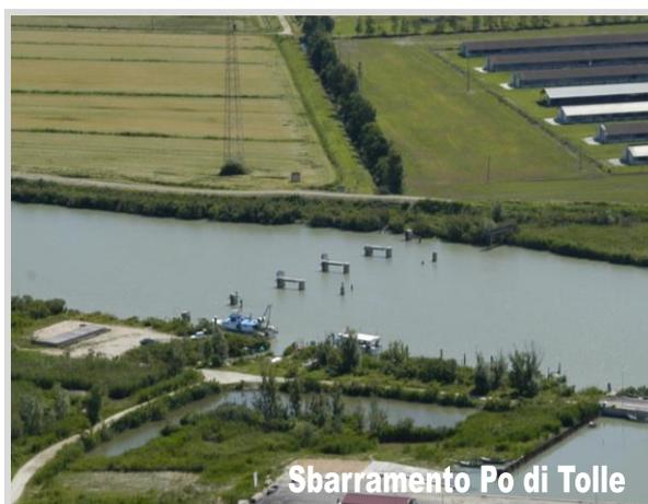
Si tratta di interventi impegnativi che vanno dalla posa in aprile ed il lievo della struttura in ottobre utilizzando natanti di notevoli dimensioni e stazza, alla manutenzione straordinaria delle strutture metalliche ed alla costante attenzione agli effetti che tali strutture possono innescare in un corso d'acqua.
